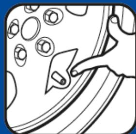
☞ Spannring richtig einsetzen und Ventilaussparung beachten.
