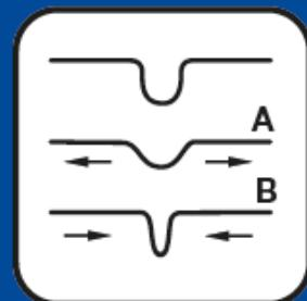
☞ Weiten des Spannringes (A), wenn die Blende zu locker sitzt, oder verengen des Spannringes (B), wenn die Blende nicht montiert werden kann.
