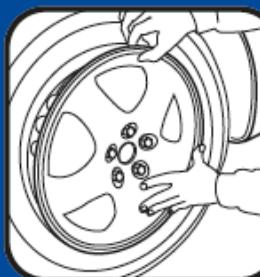
☞ Beim Aufsetzen der Radzierblende auf die Felge darauf achten, dass die Kunststoff-kralen innerhalb des Felgenhorns gedrückt werden, sonst besteht Bruchgefahr der Krallen.
