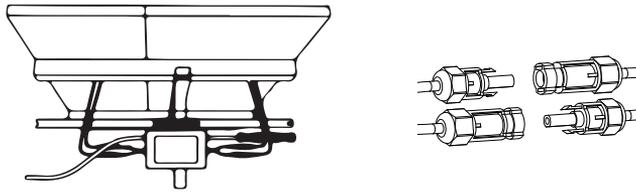
**HINWEIS:** Beim Einstecken des Gleichstromkabels (DC) der PV-Module sollte der Wechselrichter, wenn bereits Wechselstrom (AC) vorhanden ist, sofort rot blinken und innerhalb der voreingestellten Zeit (Standard 60 Sekunden) mit der Arbeit beginnen. Wenn kein Wechselstrom verfügbar ist, blinkt das rote Licht dreimal schnell und wiederholt sich nach einer Sekunde, bis Wechselstrom (AC) vorhanden ist.
