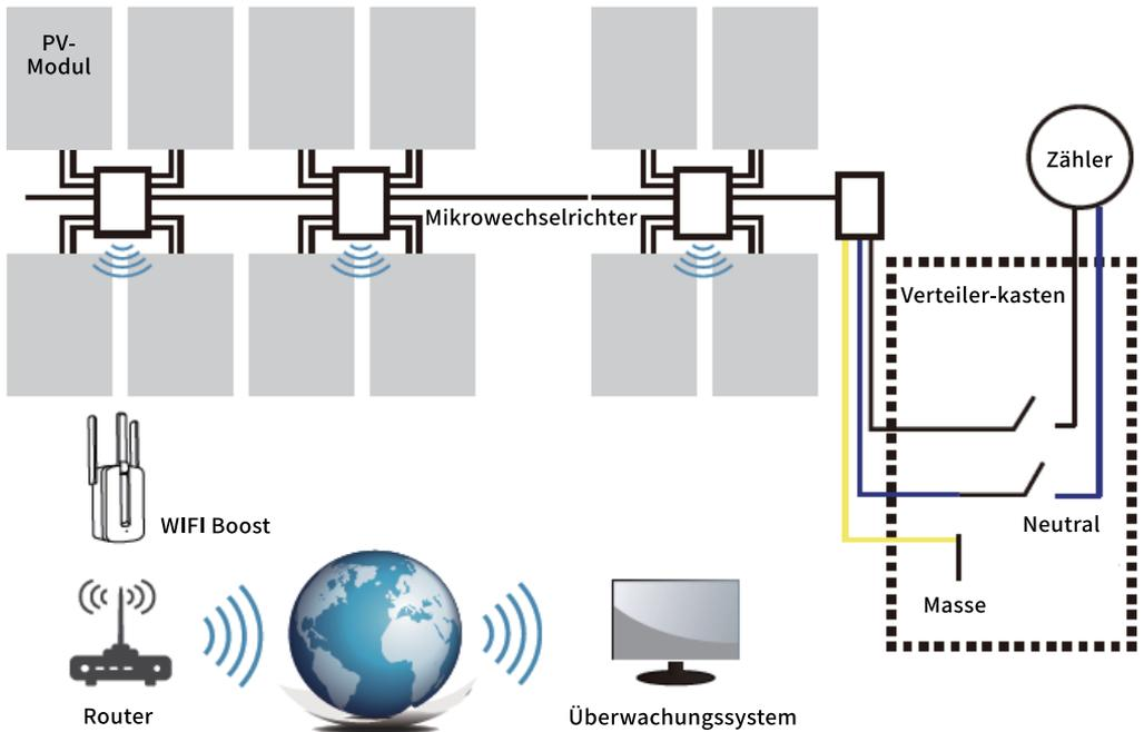
**1 HINWEIS:** Sollte das WiFi-Signal in dem Bereich in dem der Mikrowechselrichter ist, zu schwach sein, ist es notwendig, einen WiFi-Verstärker an geeigneter Stelle zwischen dem Router und dem Mikrowechselrichter zu installieren.
