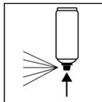
Nach Beenden des Lackiervorgangs Dose umdrehen und Ventil leersprühen.
