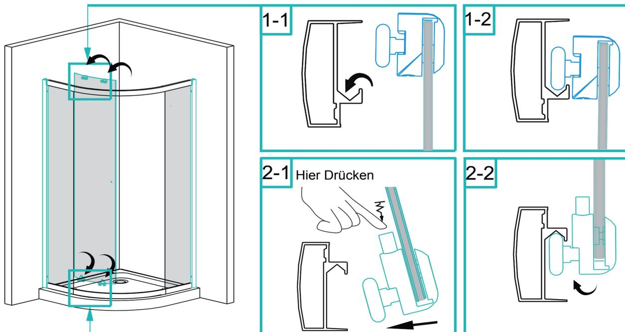
Bitte hängen Sie die oberen Laufrollen in die obere Laufschiene ein. Anschließend drücken Sie bitte die unteren Laufrollen nach unten und schieben diese in die untere Laufschiene.
