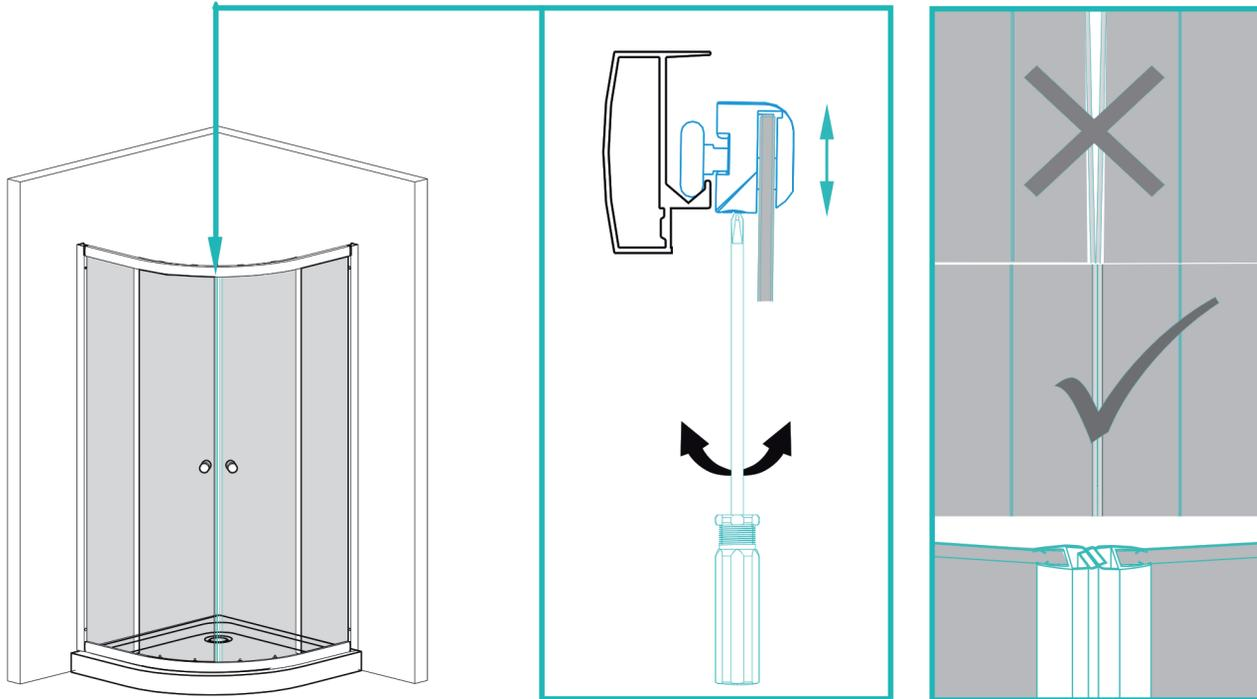
Wenn die Schiebetüren nicht richtig schließen oder ein Spalt zwischen den Magnetleisten oben oder unten entsteht, dann müssen Sie zum Ausrichten der Kabine die Schrauben an den oberen Laufrollen im oder gegen den Uhrzeigersinn drehen.
