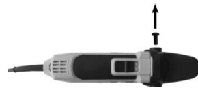
Figure 10 : Retirer la vis à six pans creux
