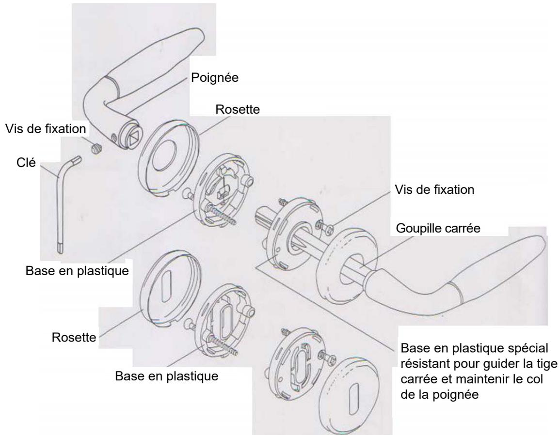
1. Insérer la poignée avec la goupille carrée dans l'écrou carré de la serrure et l'aligner avec le gabarit de montage fixé à l'aide de l'échelle millimétrée.
