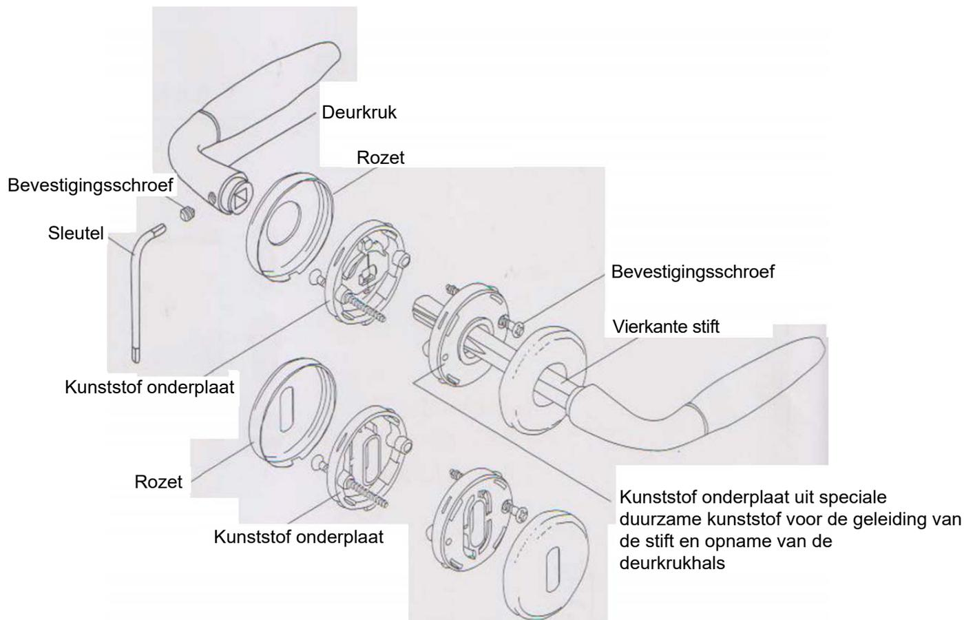
1. Steek de deurkruk met de vierkante stift door het vierkante gat van het slot en richt deze uit met behulp van de millimeterschaal van de aftekenmal.
