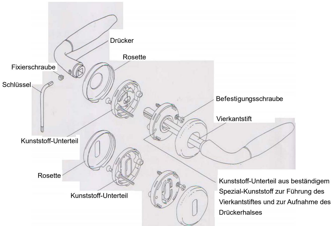
1. Drücker mit Vierkantstift in die Vierkantnuss des Schlosses stecken und mit aufgesteckter Montage-schablone mit Hilfe der Millimeterskala ausrichten.
