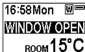
6b.33 Nachdem die Innentemperatur angestiegen ist oder eine manuelle Übersteuerung der Warnung (durch Bestätigen der Fernbedienung) erfolgt ist, kehrt das Gerät in den normalen Betriebszustand zurück.
