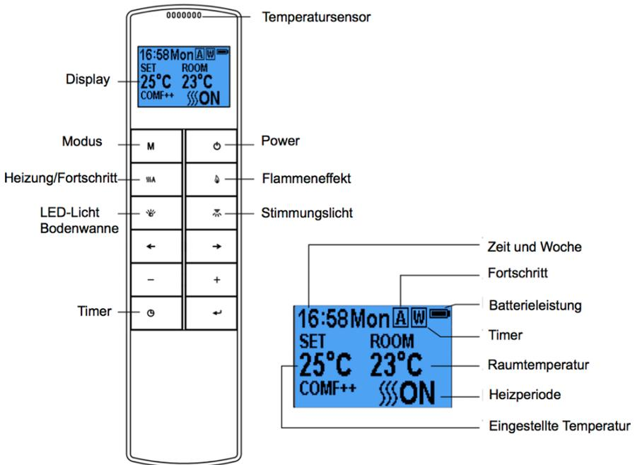
**HINWEIS:** Dies ist eine thermostatische Fernbedienung. Die Fernbedienung sollte sich im selben Raum wie der Kamin befinden und auf einer ebenen Fläche stehen. Die Fernbedienung muss vom Kamin weg platziert werden, damit die heiße Luft nicht den thermostatischen Messwert beeinflusst.
