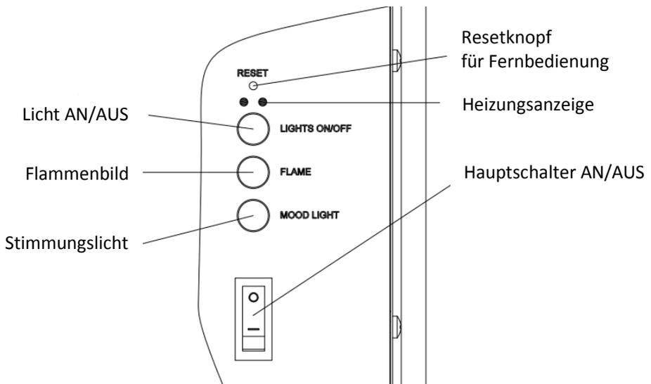
HINWEIS: Die manuelle Taste steuert grundlegende Funktionen, jedoch nicht alle Bedienelementen. Verwenden Sie die Fernbedienung, um alle Funktionen auszuführen.
