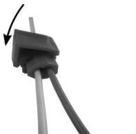
Afb. 6: De bevestigingsbeugel sluiten
