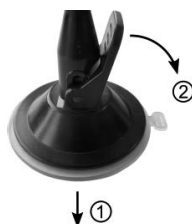
Figura 9: Applicare il supporto
