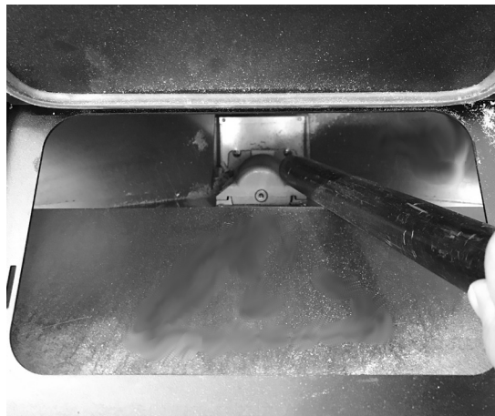
Fig. 25 - Reinigung Tank und Schnecke
