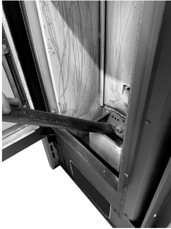
Fig. 23 - Reinigung Fach Brennschale
