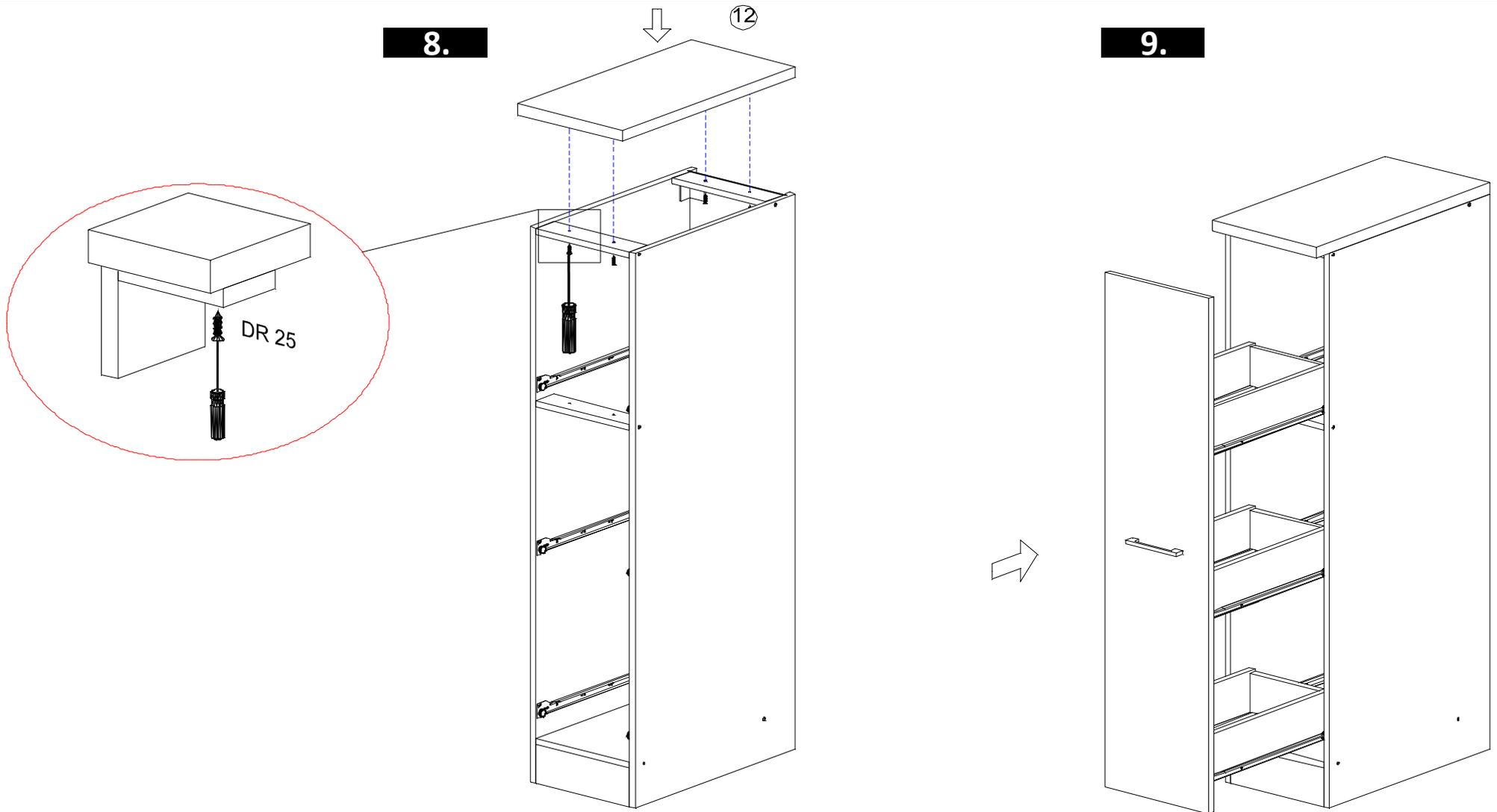
Falls beim Ausziehen die Tür nicht leichtgängig genug funktioniert, bitte die Schrauben DR25 lösen. Beginnen Sie mit der mittleren Schublade. So kommt die Schublade auf die richtige Position und so können Sie auch die Schrauben DR25 richtig einschrauben.
