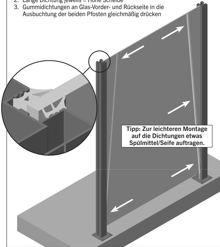
**5** Abdeckblenden in die ungenutzten Ausbuchtungen der Pfosten einschieben
