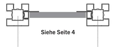
**1** Pfostenanker fachgerecht betonieren oder anschrauben bzw. Pfosten direkt einbetonieren
