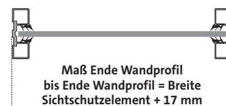
**!** Bei Montage von Holzelementen mit optionalem Winkelprofil
