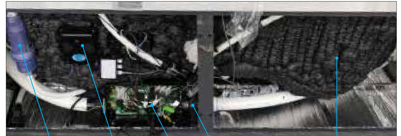
Ozon-Mischkammer Ozongenerator Steuerung Heizung Verdunkelung Isolierung
