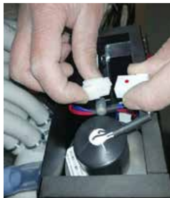
3. Schritt: Weisse Verbindungsstücke entkuppeln
