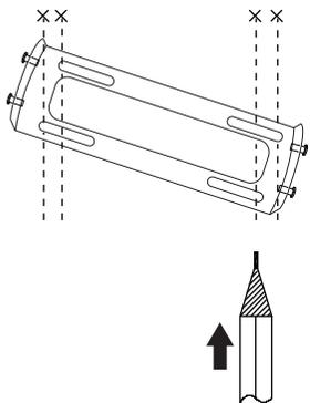
Deckenhalterung von der Leuchte / Ventilator abschrauben und Bohrpunkte festlegen.
