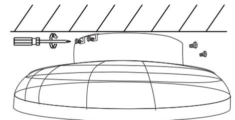
Ventilator / Leuchte mit der Halterung verschrauben.
