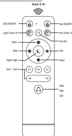
Mit der beiliegenden Fernbedienung können der Ventilator und die Leuchte ein-/ausgeschaltet werden, sowie die Funktionen geändert werden (Siehe Punkt 4)
