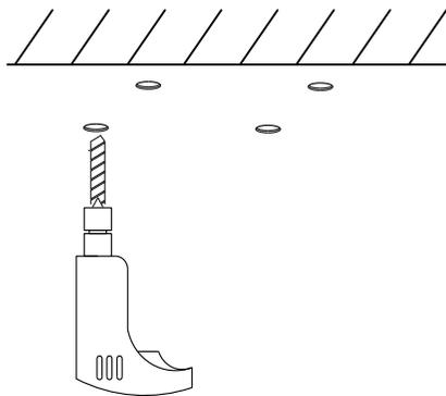
Bohrpunkte entsprechend auf tragfähigen Untergrund bohren und verdübeln.
