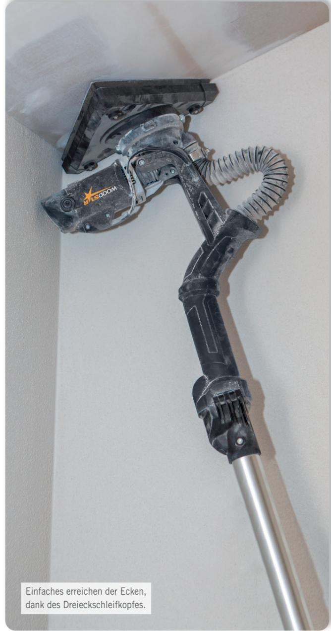
Einfaches Erreichen der Ecken, dank des Dreieckschleifkopfes.
