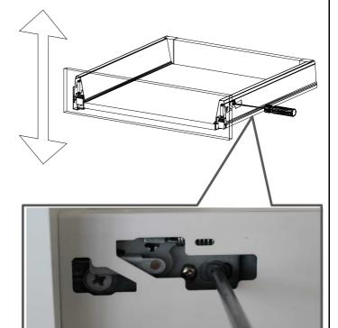
Mit Betätigung der vorderen Schraube wird die Fronteinstellung in horizontaler Richtung vorgenommen!
