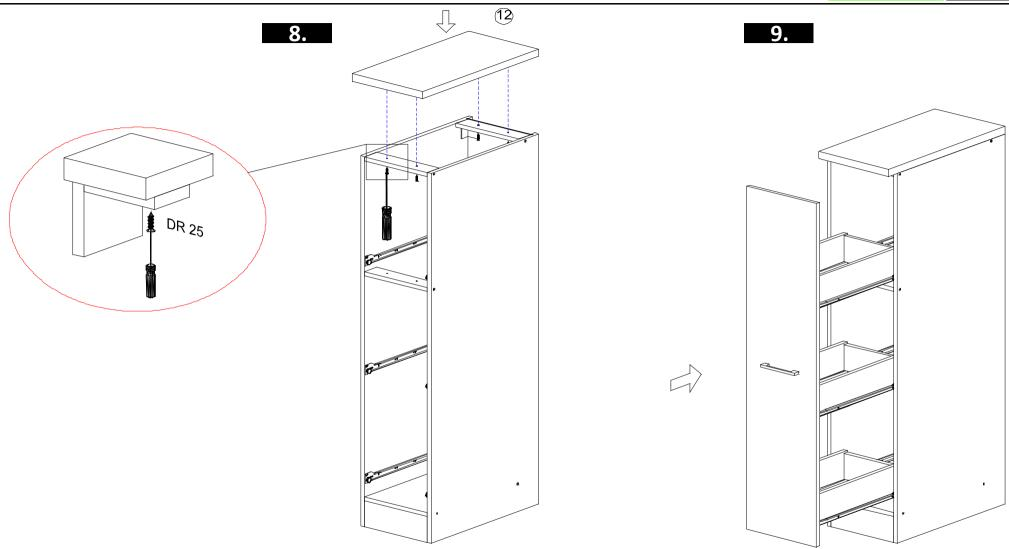
Falls beim Ausziehen die Tür nicht leichtgängig genug funktioniert, bitte die Schrauben DR25 lösen. Beginnen Sie mit der mitlleren Schublade. So kommt die Schublade auf die richtige Position und so können Sie auch die Schrauben DR25 richtig einschrauben.
