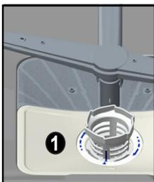
Um die Filterkombination herauszunehmen und zu reinigen, müssen Sie sie entgegengesetzt zum Uhrzeigersinn (nach links) drehen und dann herausnehmen. **1**
