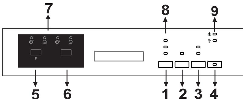
Sie können die Maschine über die Ein-/Austaste (4) einschalten. Die Ein-/Aus-Leuchten leuchten, solange die Maschine eingeschaltet ist. Drücken Sie zum Einstellen des gewünschten Programms die Programm-Taste (5).
