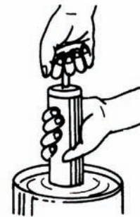
Abb.4: Befüllung mittels Ansaugen
