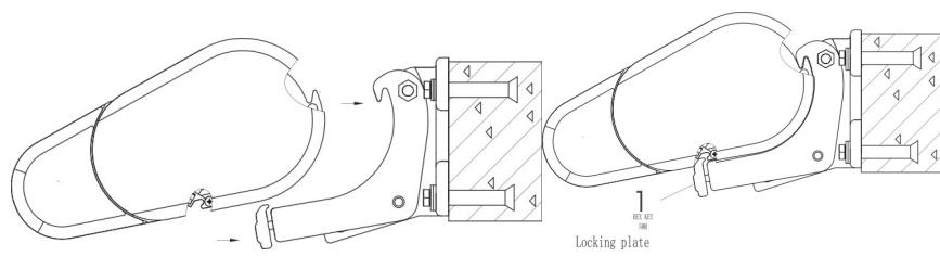
Führen Sie die Markise in den Befestigungswinkel ein, wie in der Abbildung gezeigt. Befestigen Sie die Markise mit dem mitgelieferten Sicherungsblech und der Sicherungsschraube und ziehen Sie diese ordnungsgemäß an.
