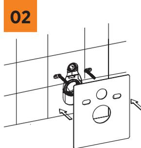
Setzen Sie den Schallschutz auf die Stockschrauben auf.
