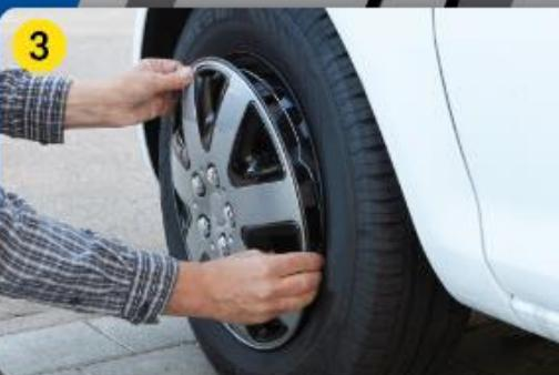
① Radzierblende so auf die Felge aufsetzen, dass der Ventilschaft durch die Aussparung am Spannring geführt wird.
