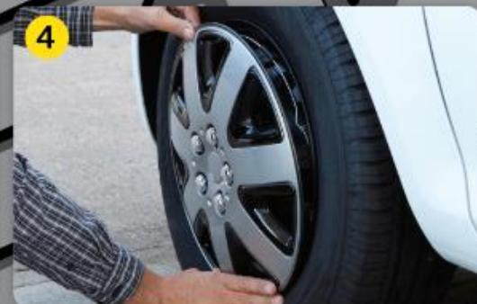
① Blende unter leichtem Druck auf deren Rand, ringsherum auf die Felge drücken. Sitzt die Blende zu locker, die Schritte 1-3 wiederholen, den Spannring allerdings in Öffnung **C** einstecken.
